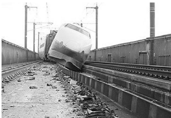
写真 2 上越新幹線脱線現場
