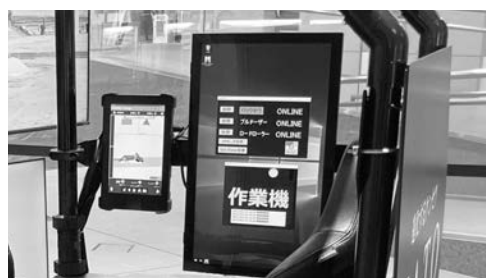
写真－3 建設機械の切替画面
