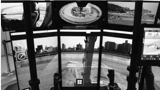
写真-7 AR映像（3次元設計データ）
