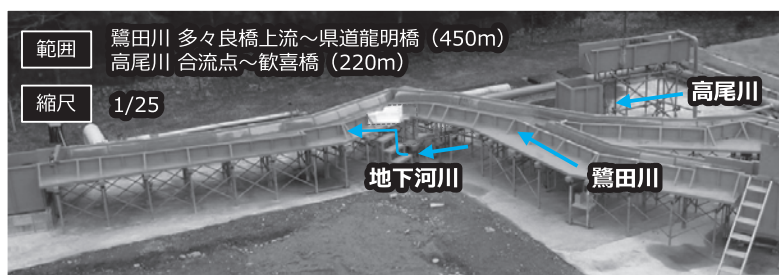
写真-4 流出施設実験模型
