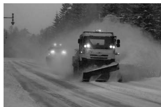
写真－22 除雪状況（新雪除雪）
