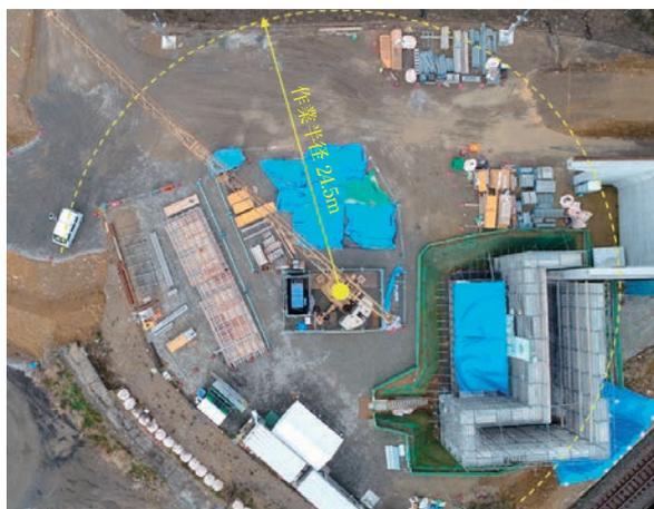
写真-2 定置式水平ジブクレーンの作業範囲
