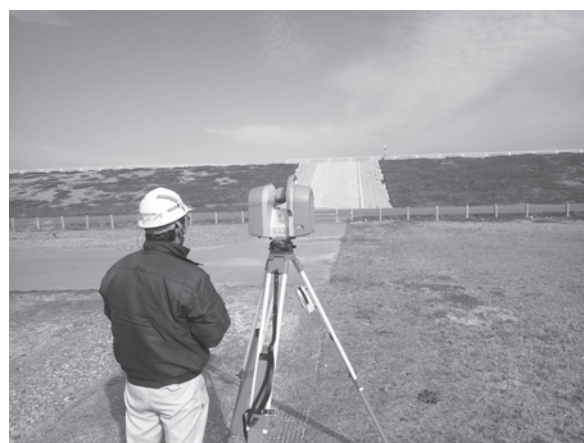
写真－4 TLS による 3 次元測量状況(Trimble TX8)
