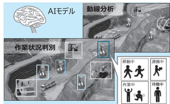
図-3 AI による建機・作業員の作業判別例
