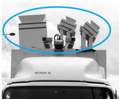
図－３ 開発レーダの計測車両への搭載状況
