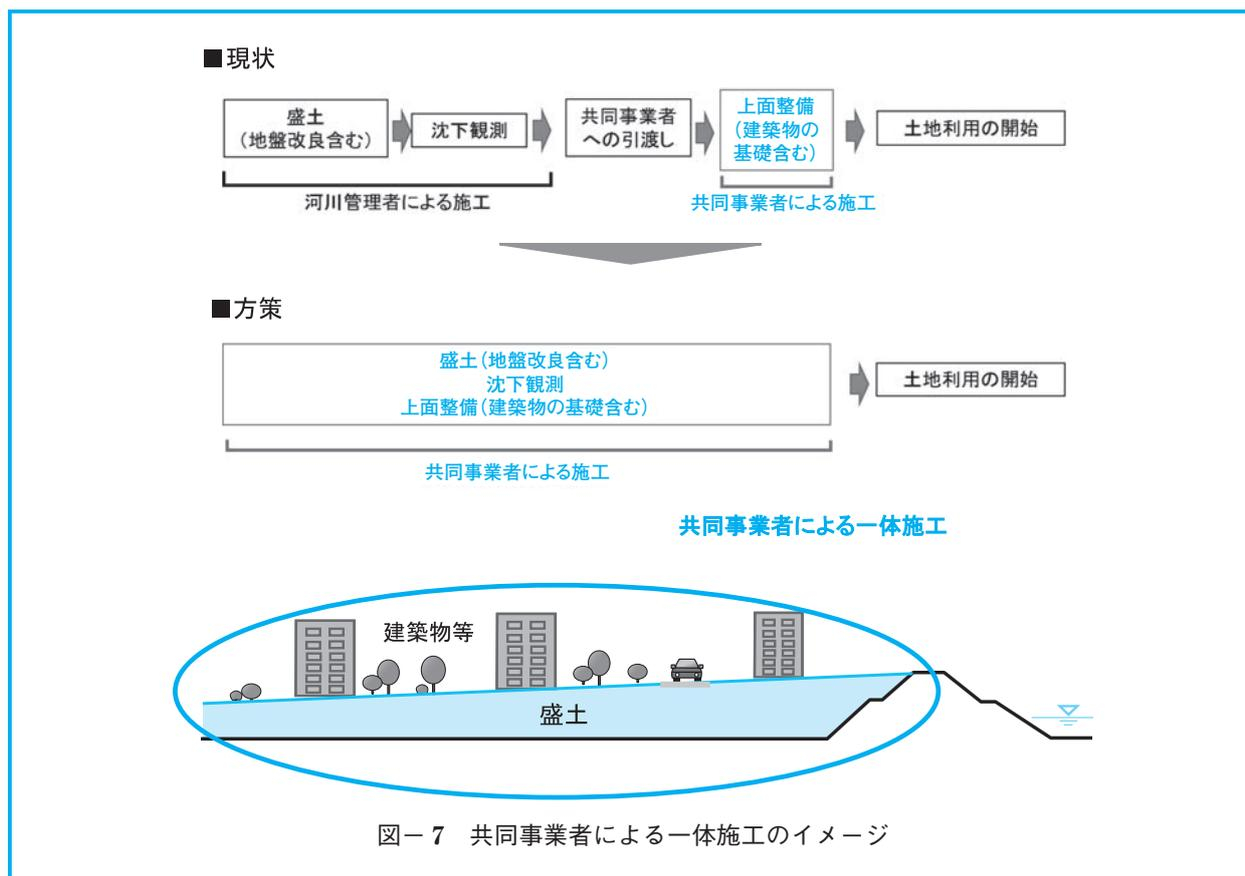
に向けて、高規格堤防の盛土や地盤改良等と建築物や基礎等を一体的に施工することができる仕組みづくりをすべきであると提言されています（図-7）。
