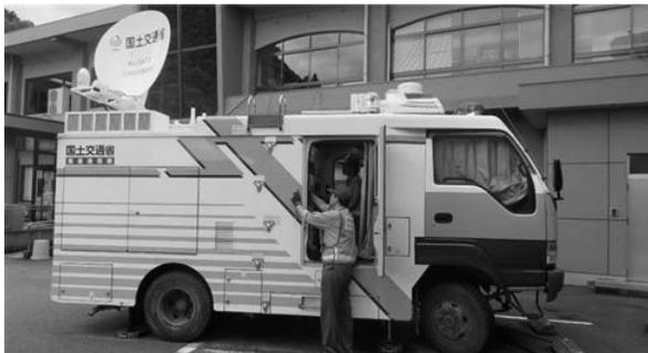
写真－12 東峰村に衛星通信車を派遣し通信を確保
