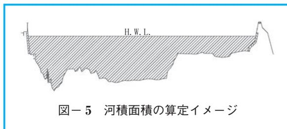
図-5 河積面積の算定イメージ
