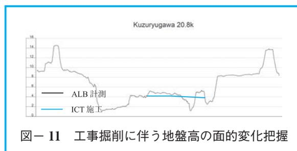
図-11 工事掘削に伴う地盤高の面的変化把握
