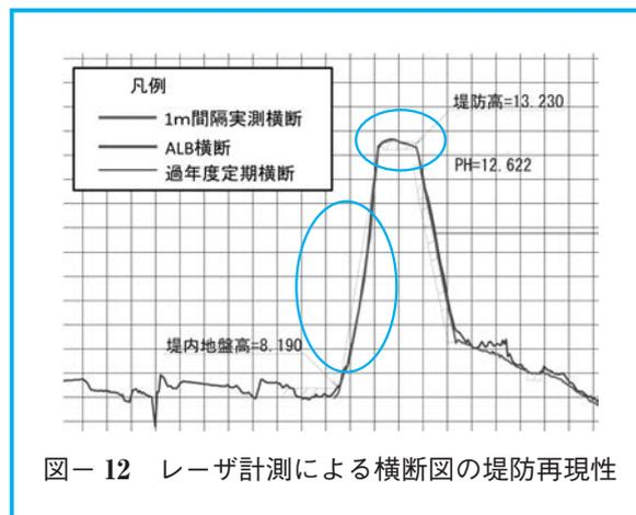
図-12 レーザ計測による横断図の堤防再現性
