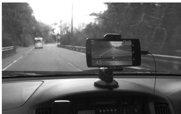
スマートフォンによる簡易路面性状調査
