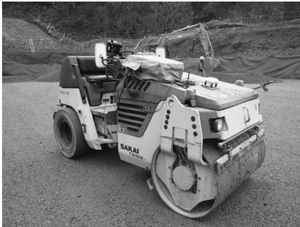
写真-11 GNSS 転圧管理システム
