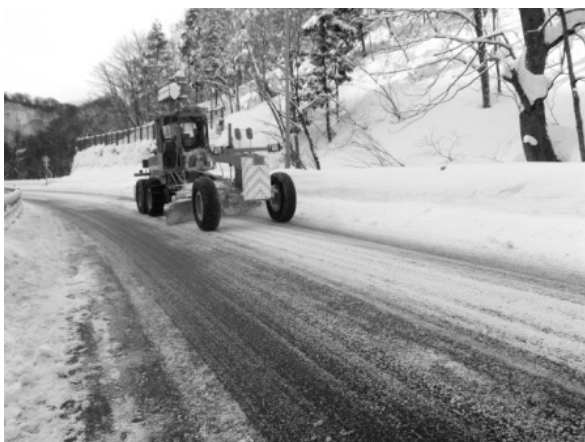
写真-7 除雪グレーダによる除雪状況
