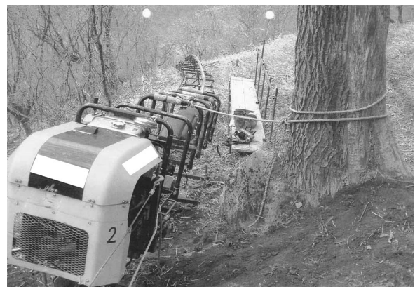
写真 1 作業員運搬用モノレールによる事故
