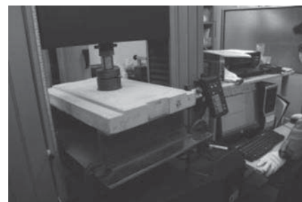
写真一2 押抜き試験状況
