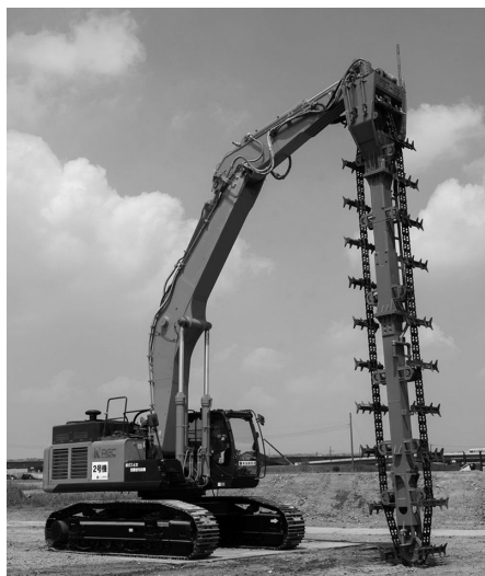
写真一 中層混合処理機（トレンチャ式）外観
