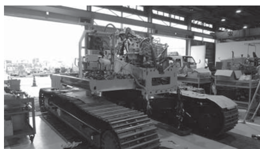
写真三 分解組立型バックホウの分解状況(1)
