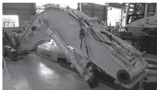
写真四 分解組立型バックホウの分解状況(2)
