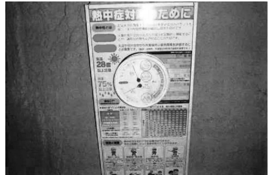
写真 4 WBGT看板の設置
