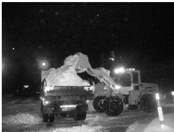
写真 4 除雪ドーザ運搬除雪状況
