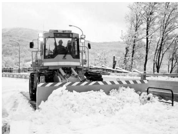
写真 3 除雪ドーザ作業状況 (2名搭乗)
