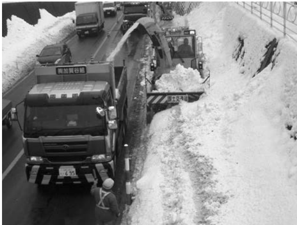
写真 5 ロータリ除雪車による運搬除雪
