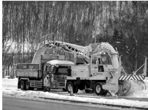
写真 6 一車線積込除雪車による運搬除雪
