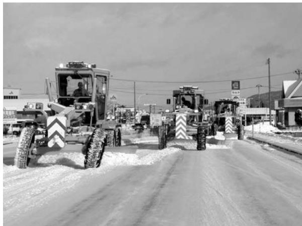
写真 1 除雪グレーダによる除雪（雁行作業）
