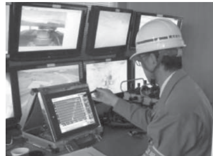
写真二 平板載荷試験（JGS1521）に準じた測定状況
