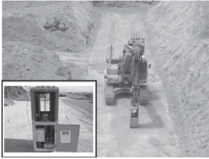
写真一 簡易支持力測定器による測定
