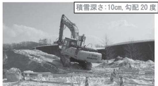
写真一七 登坂実験状況（資料提供：北海道開発局）
