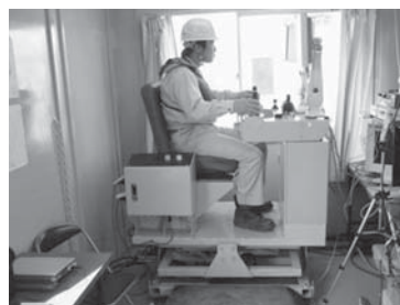
写真一七 遠隔操縦型水中作業ショベル
