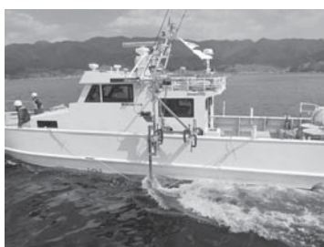
写真一六 音響探査による水底の調査
