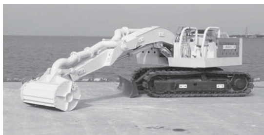
写真一七 遠隔操縦型水中作業ショベル
