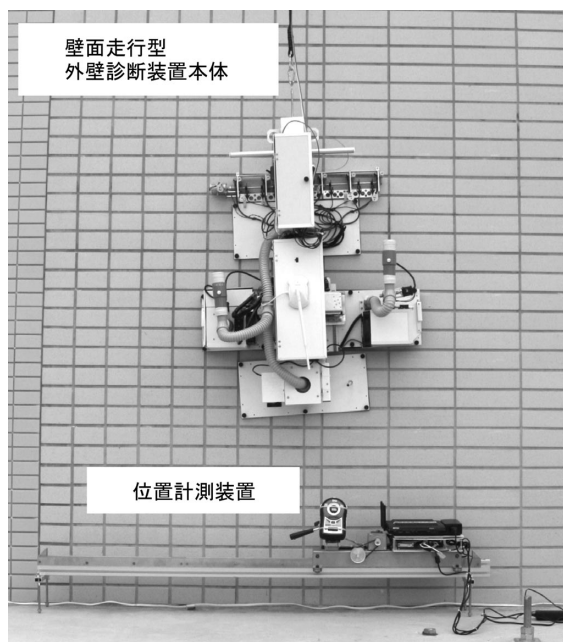
写真 5 壁面走行型外壁診断装置および位置計測装置
