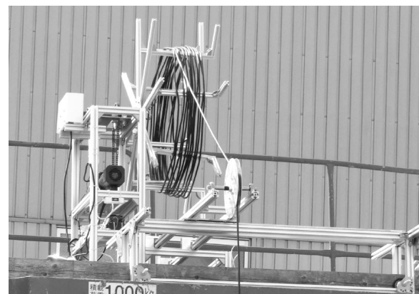
写真 4 落下防止装置兼電源供給用リールユニット
