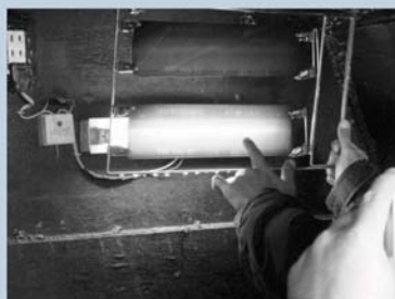
現場溶接部X線検査状況
