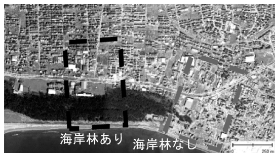
写真 1 海岸林がある場所の方が無い場所よりも背後地の流出家屋の被害が少ない（石巻市）
