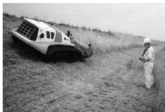
写真-1 遠隔操縦草刈機による除草
