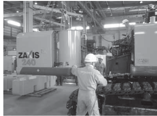
写真 10 エンジンフレーム組立
