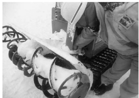
写真 1 雪を除去するため投入口から手を差し入れた
