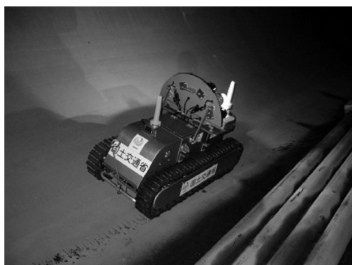
写真－12 管内調査
