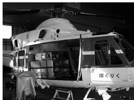
写真-7 ユニットの固縛状況
