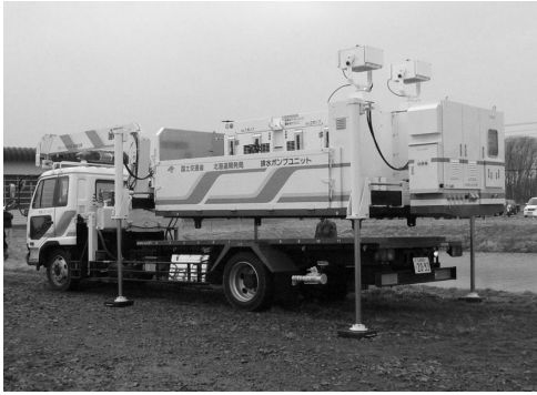
写真 6 排水ポンプユニット搭載作業
