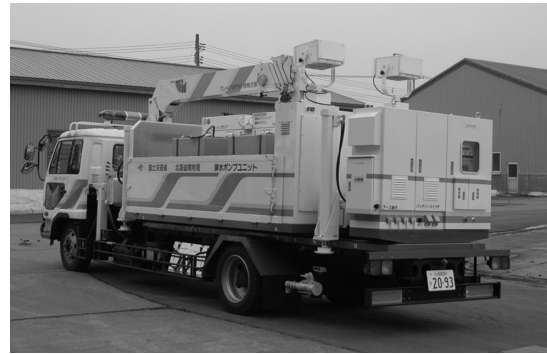
写真 3 多機能型災害対策車 排水ポンプユニット搭載時
