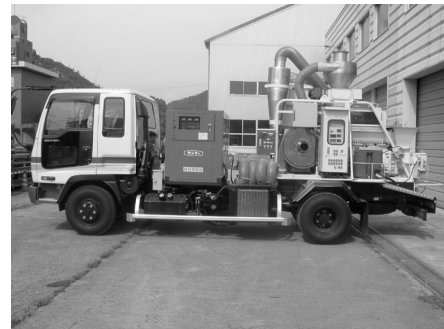
写真 7 刈草 RDF 製造装置
