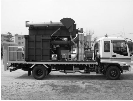
写真 8 刈草 RDF 炭化物製造装置
