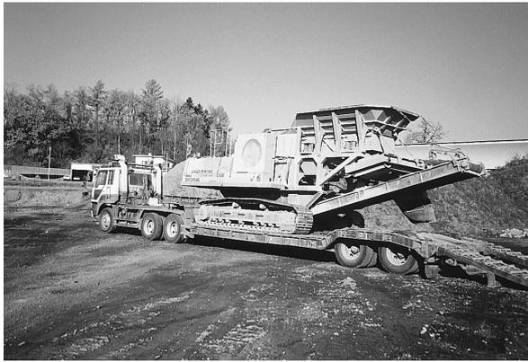
写真 4 自走式破碎機の搬出状況
