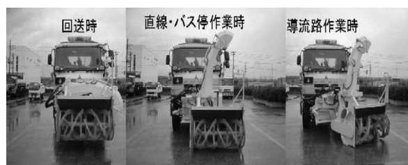
写真 1 作業時と回送時の状態
