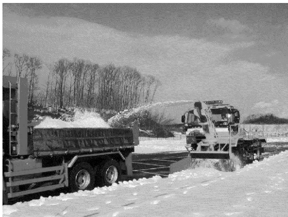
写真 3 運搬排雪試験状況
