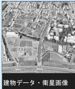
図 1 3次元データを活用したCG作成のイメージ (3次元で設計したデータや地形データを入力データとして、住民説明用のCGをこれまでより効率的に作成することができる)
