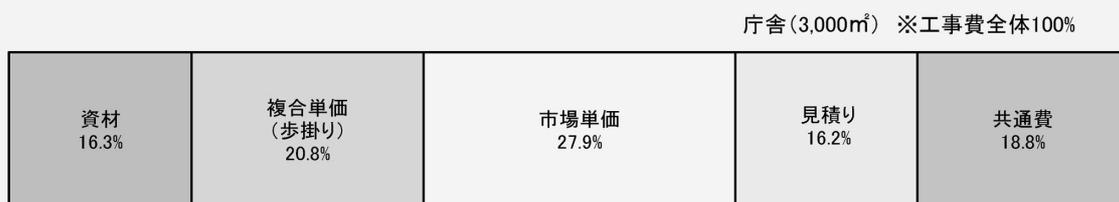
図 2 建築工事の工事価格構成比（単価別）
