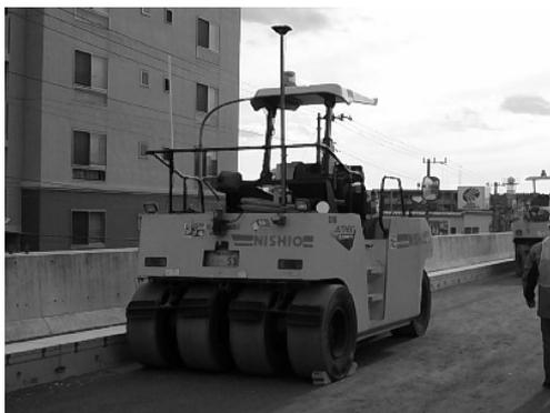
写真 3 締固め回数管理システムを搭載したホイールローラ
