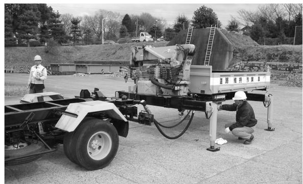
写真 3 脱着作業性試験状況
