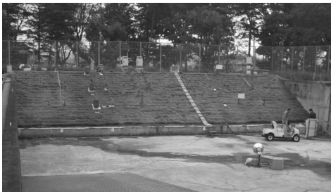
図4 堤防模型による堤体内水位計測実験
