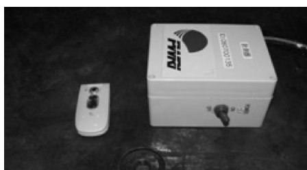
図 2 橋脚の地震被災度判定センサ
