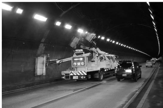
写真 1 トンネル清掃車（従来機）
