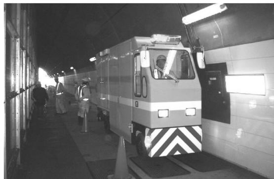
写真 2 小幅トンネル清掃車（試作機）
