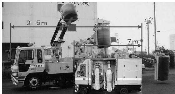
写真 3 小径トンネル清掃車試作機(従来機との比較(合成写真))
