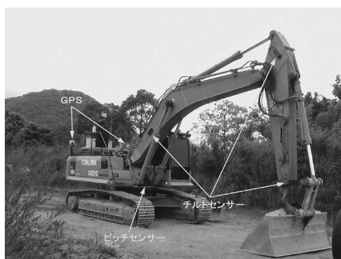
写真 4 システム搭載油圧ショベル
