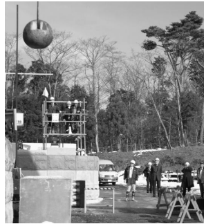
写真-11 2tの鉄球による落下衝撃試験状況
