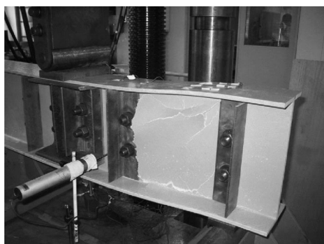
写真 1 FRP 接合部の破壊の例
