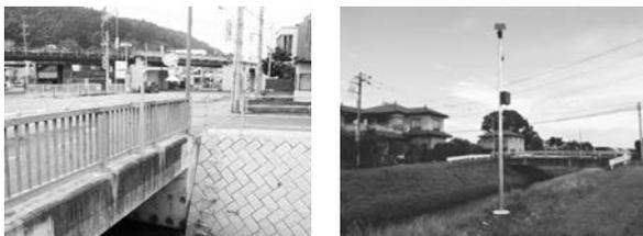
写真－7 左：危機管理型水位計，右：簡易型河川監視カメラ
