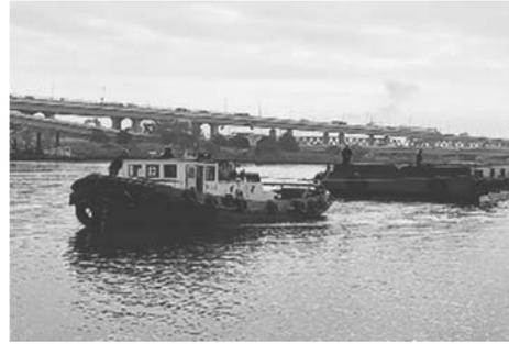
写真-3 引船で土運船を曳航している状況
