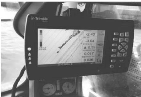
写真-2 バックホウに搭載した ICT 機器
