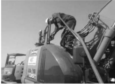
写真-12 バックホウ給油状況
