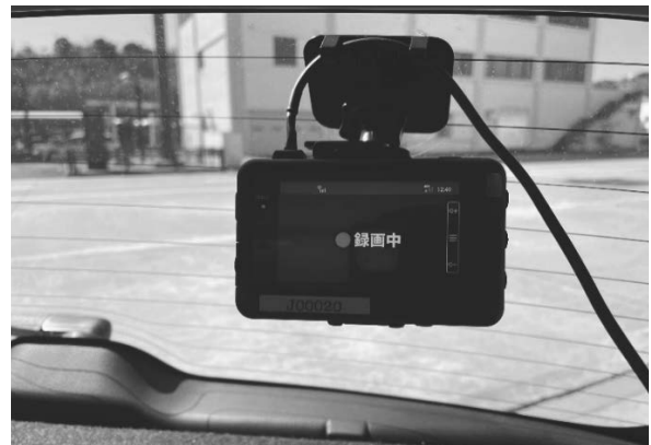
写真-2 ドラレコ設置状況
