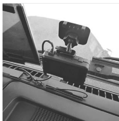
写真－10 ドラレコ設置状況
