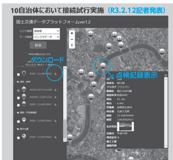
図-8 国土交通データプラットフォームと地方自治体データベースとの接続試行
