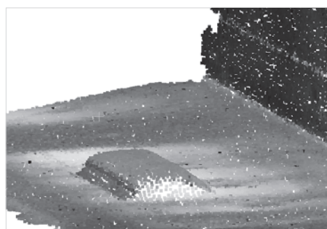
図-4 iPhone 12 Pro のLiDAR で計測した2 cm の凸部 (バリア箇所)
