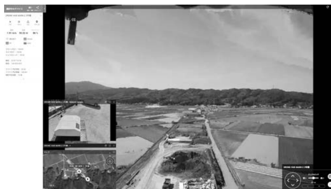
図-3 UAVを用いた遠隔臨場画面
