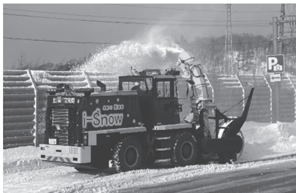
写真-1 道路附属物等の障害物を避けた投雪作業
