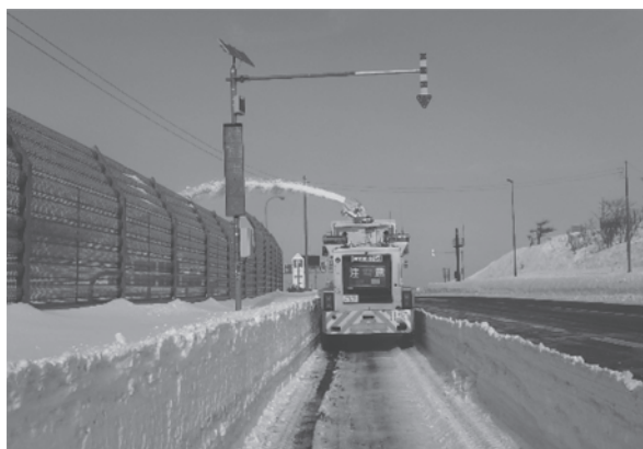
写真-2 シュート自動制御安定性試験
