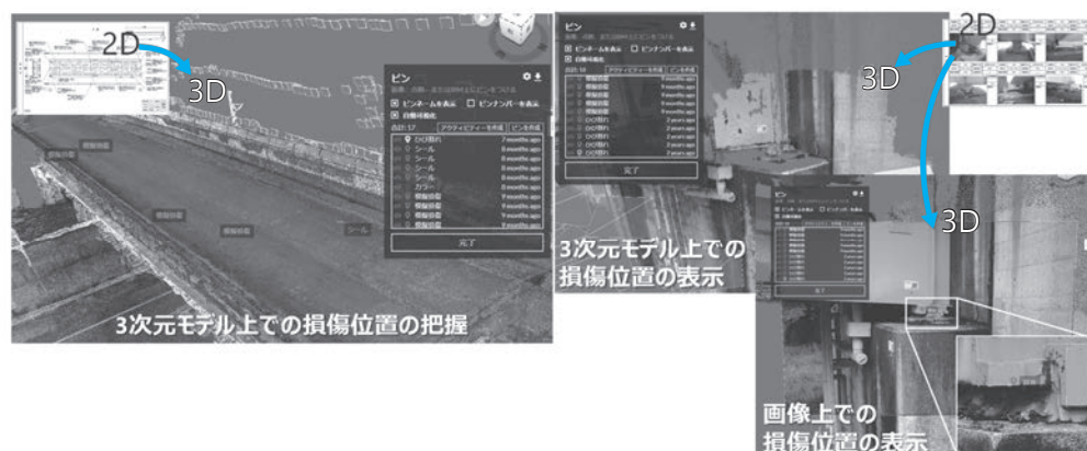
図-4 3 次元モデルを活用した損傷表現
